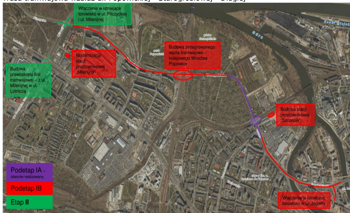
Trasa tramwajowa wzdłuż ul. Popowickiej - Starogrobłowej - Długiej
