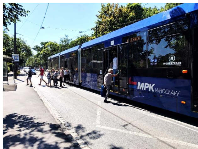
Rys. 4.50 Nowe tramwaje z małą częścią niskopodłogową.
