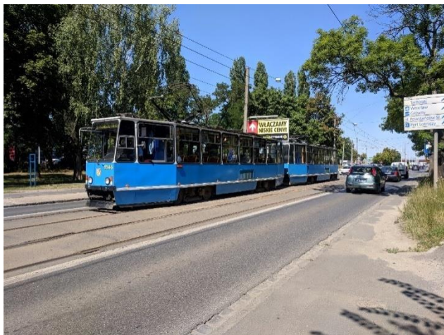
Rys. 4.51 Przestarzały, nieklimatyzowany i wysokopodłogowy tabor tramwajowy.
