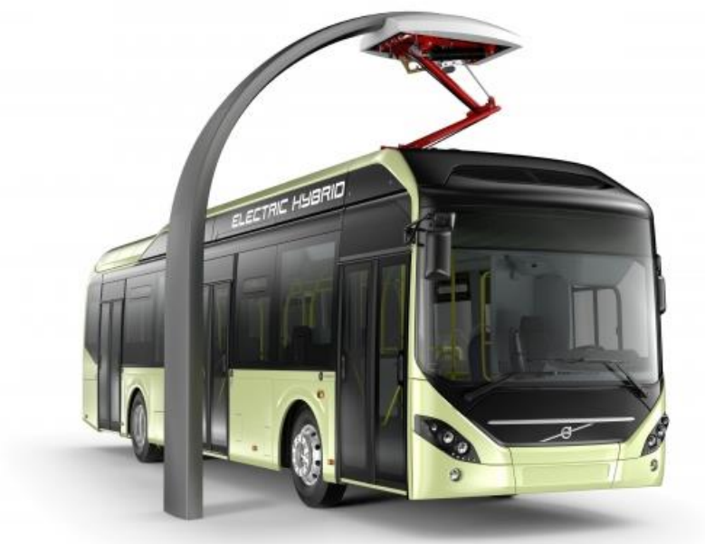
Rys. 6.3 System ładowania Volvo przy użyciu pantografu 56
