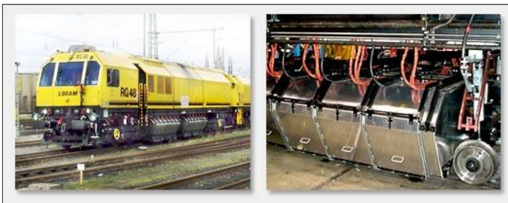
Rysunek 28. Widok maszyny do szlifowania szyn RG 48 I +II ( www.schweerbau.de/ ).
