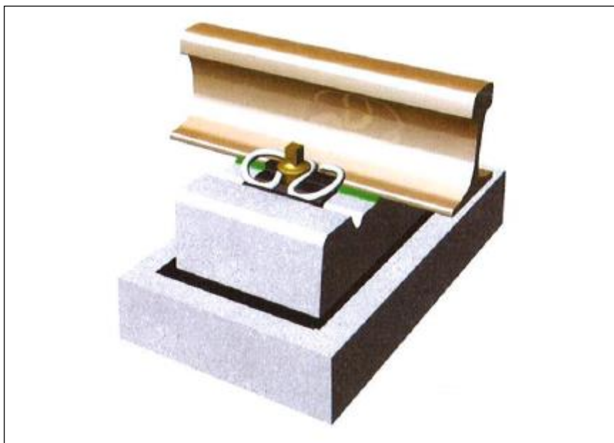
Rysunek 25. Przykładowy system podpór blokowych w otulinie ( http://www.tines.pl ).
