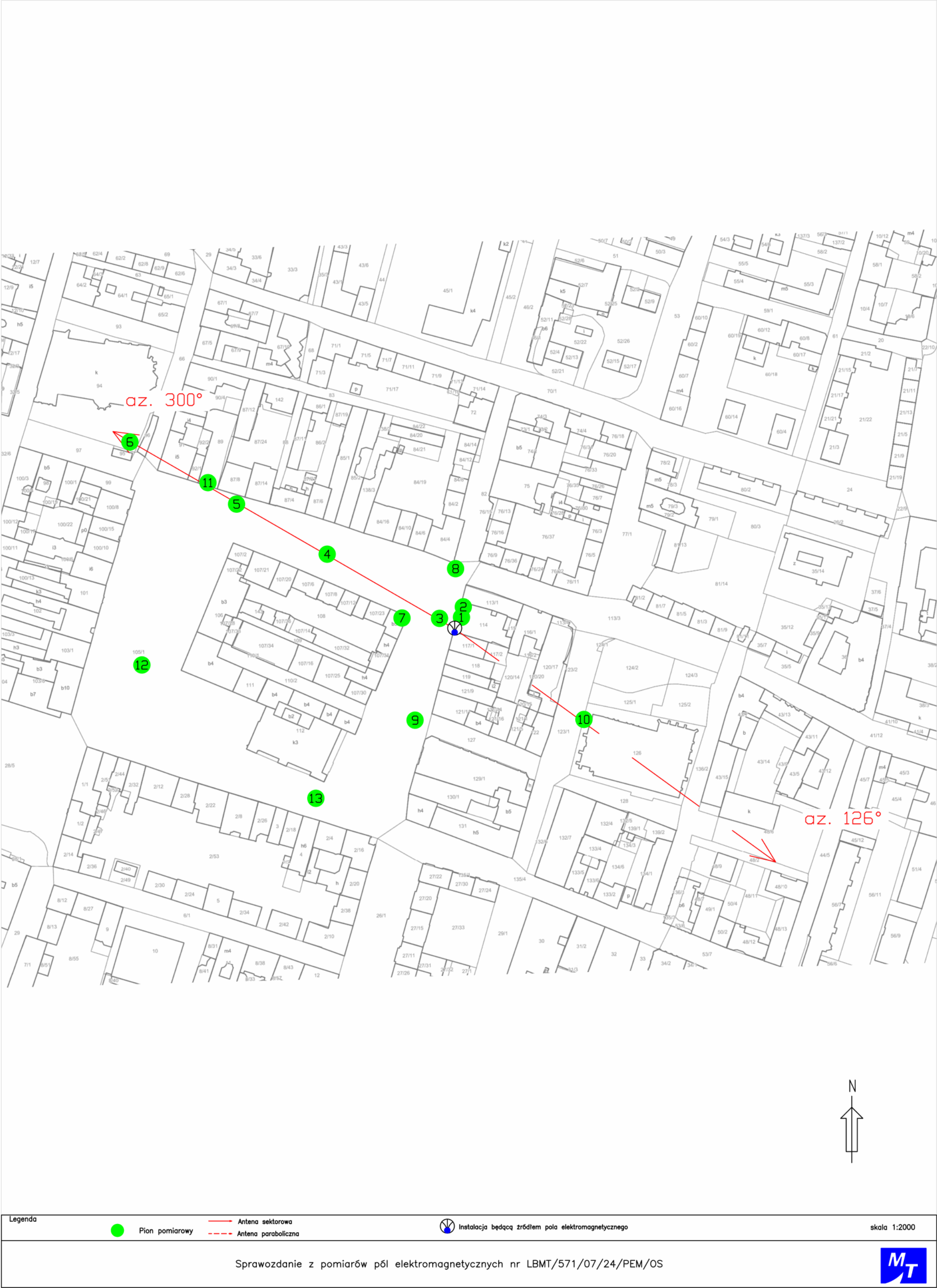
Rys.1 Lokalizacja pionów pomiarowych
