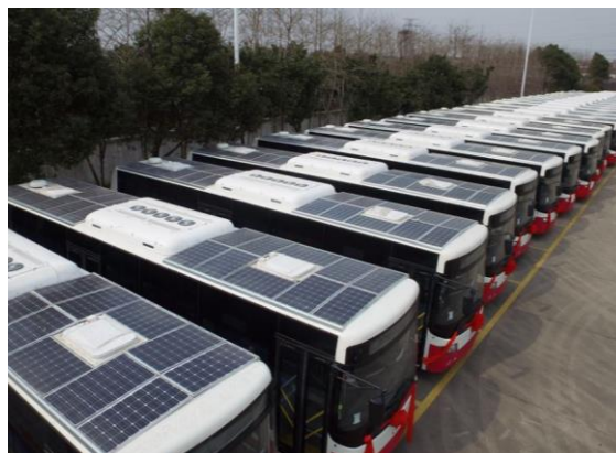
Zdjęcie 21 Ogniwa PV na dachach chińskich, elektrycznych autobusów miejskich
