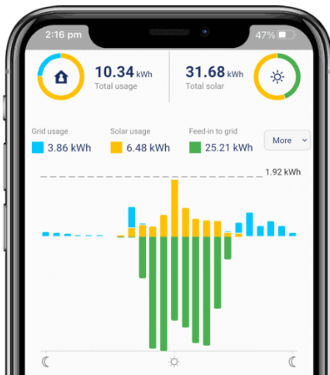
Zdjęcie 7 System monitoringu pracy instalacji PV
