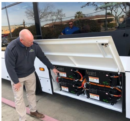
Zdjęcie 20 Sekcje akumulatorów w elektrycznym autobusie komunikacji miejskiej
