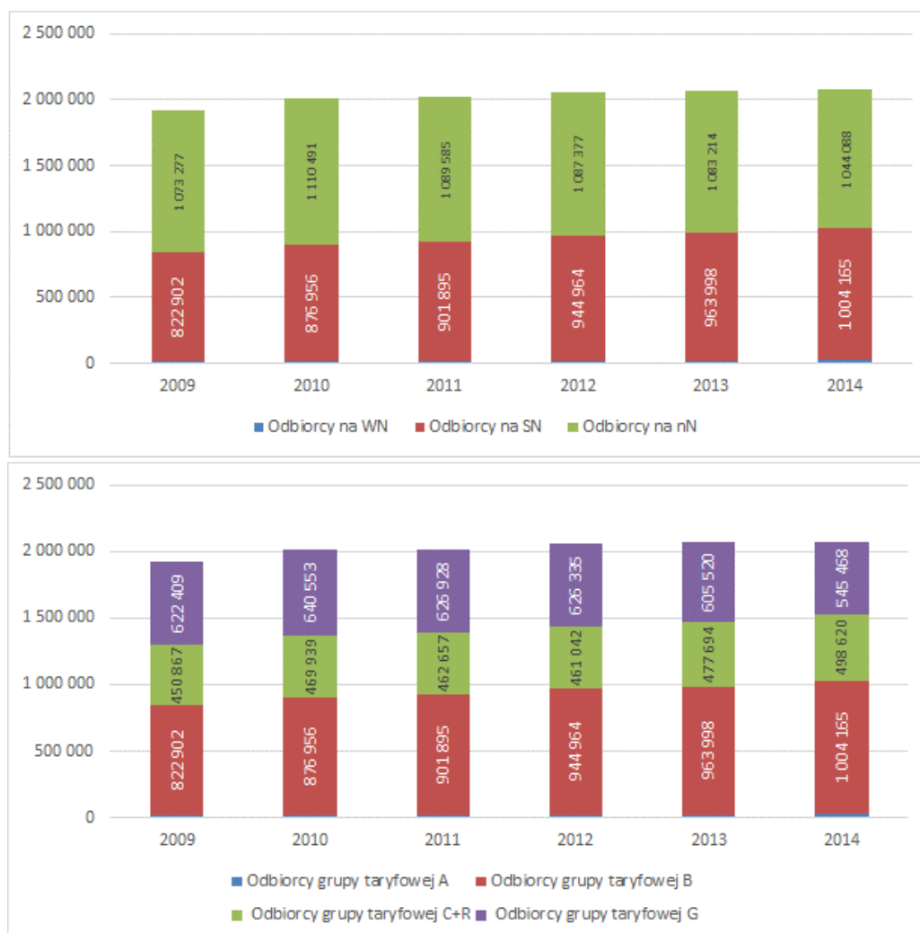
Rysunek 14. Skumulowane ilości energii elektrycznej dostarczanej do odbiorców końcowych gminy Wrocław poprzez sieć dystrybucyjną Oddziału Wrocław Tauron Dystrybucja S.A. w podziale na grupy według napięcia poszczególnych części sieci dystrybucyjnej oraz taryf usług dystrybucyjnych [MWh]
